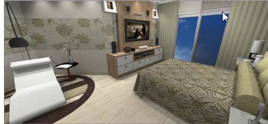
4 Imagem renderizada com o controle automático de suavização ativado. Note a diferença na intensidade dos pontos de luz.
