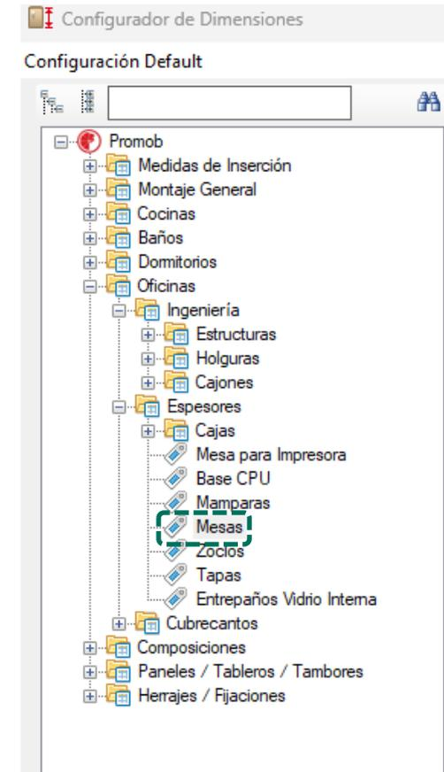
Las medidas de profundidad y altura se pueden alterar a través del **Configurador de Dimensiones**.
