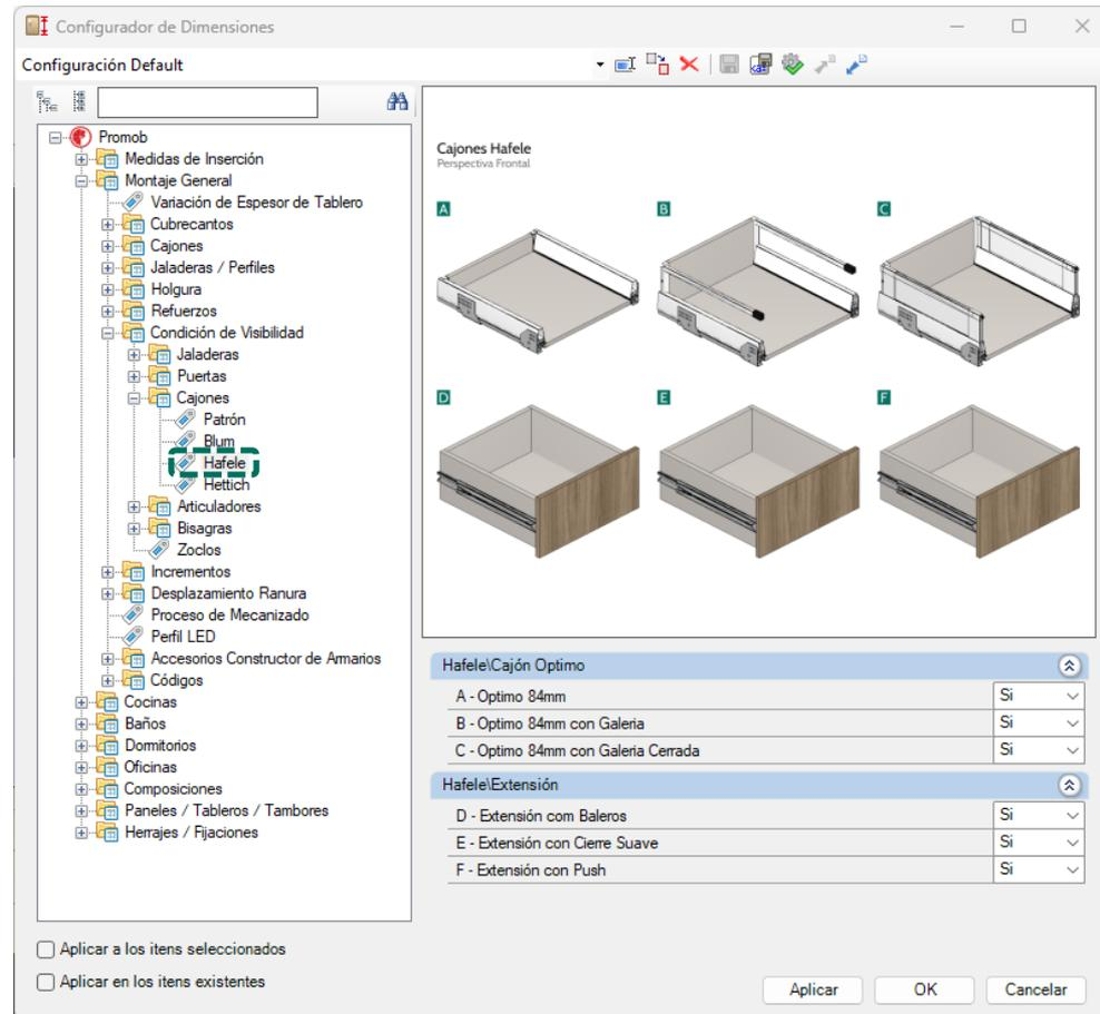
El uso de los elementos **Hafele** se definirá a través del **Configurador de Dimensiones** y sólo se insertarán con frentes de madera.
