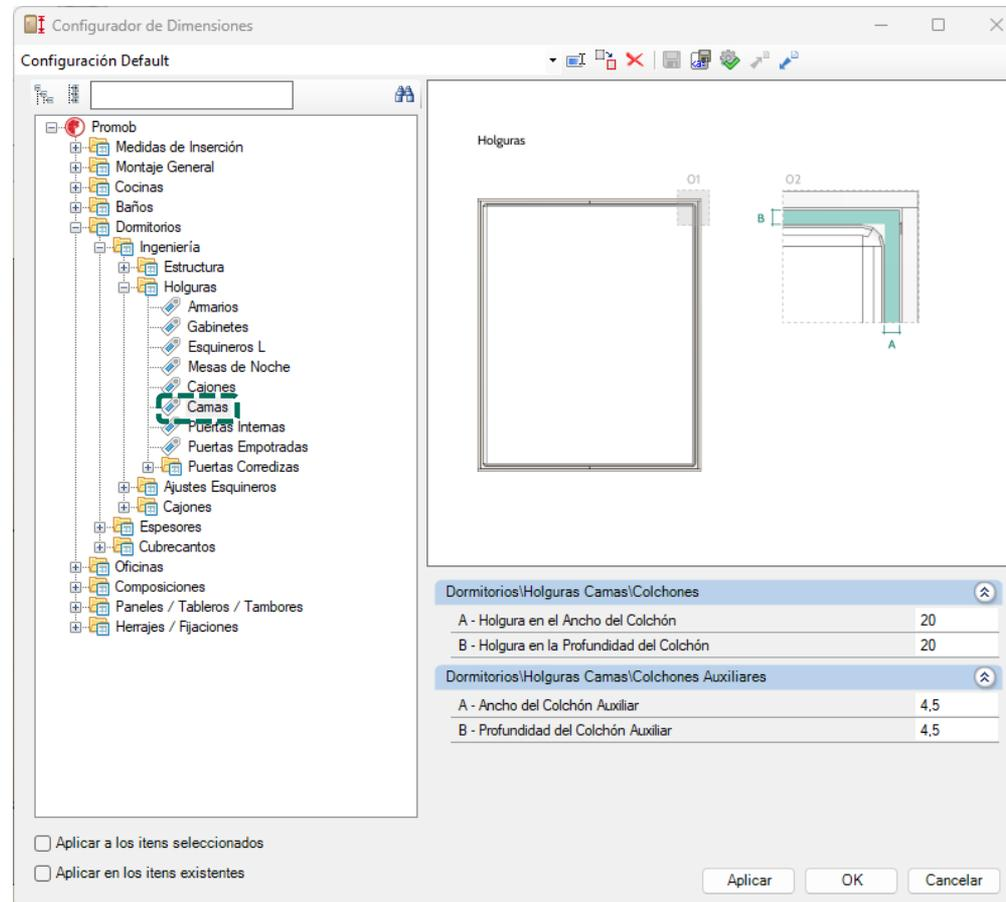
Las holguras de los componentes del módulo se pueden definir en el **Configurador de Dimensiones** en el momento del diseño.
