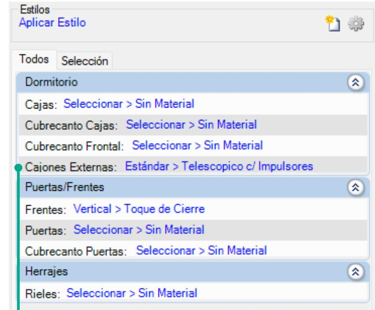
Para usar el modelo **Toque de Cierre**, es necesario cambiar el modelo de **corredera** para **Toque de Cierre**;
