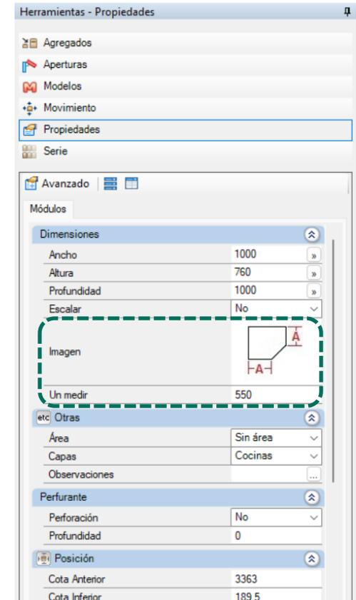
Los valores de las medidas **A** se pueden editar a través de las propiedades durante la construcción del proyecto. Base y Entrepaños enteras (enviado al optimizador de corte como una pieza entera, sin el diseño de la L). A través del **Configurador de Dimensiones** es posible elegir entre utilizar caja con recorte o sin recorte. La dimensión del **recorte de la Caja con Recorte** se puede definir a través del **Configurador de Dimensiones**.
