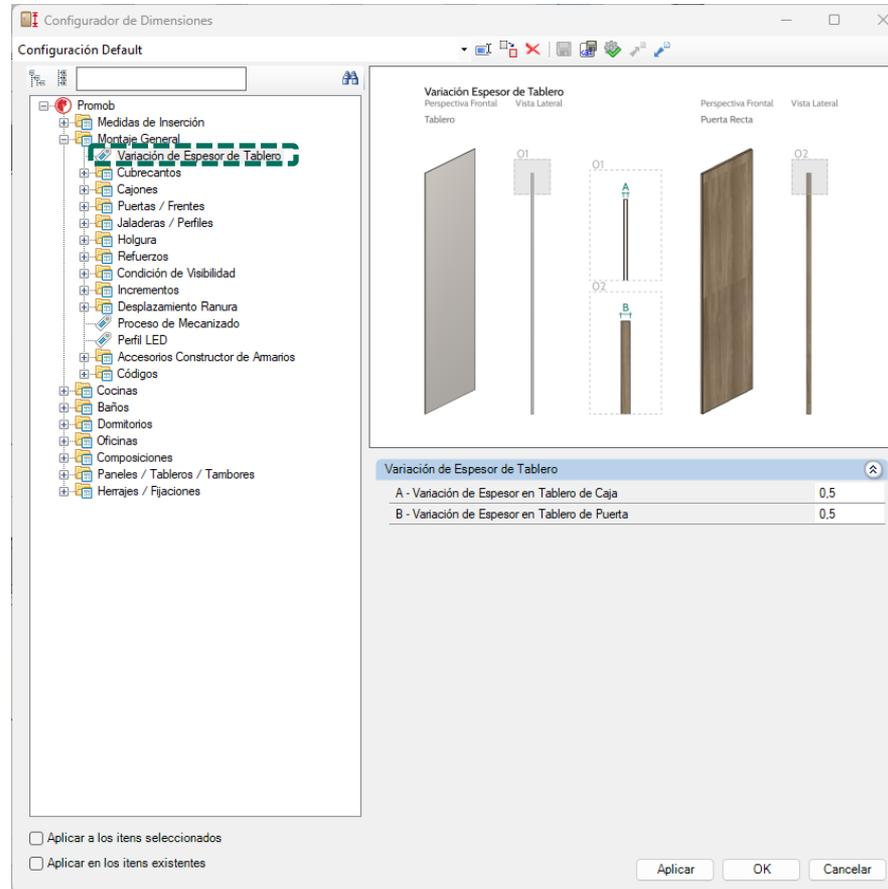
La **variación del espesor de la lámina** se definirá a través de la **Configurador de Dimensiones**.
