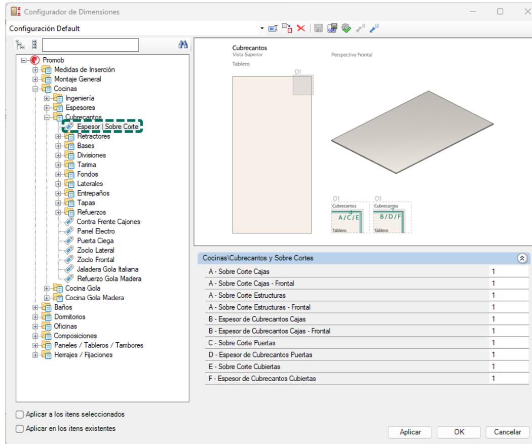
A edición de Espesor y Sobre Corte de las cajas se puede configurar a través del **Configurador de Dimensiones**. El camino mostrado arriba es el mismo para las demás líneas de modulación (Baños, Dormitorios y Oficinas).
