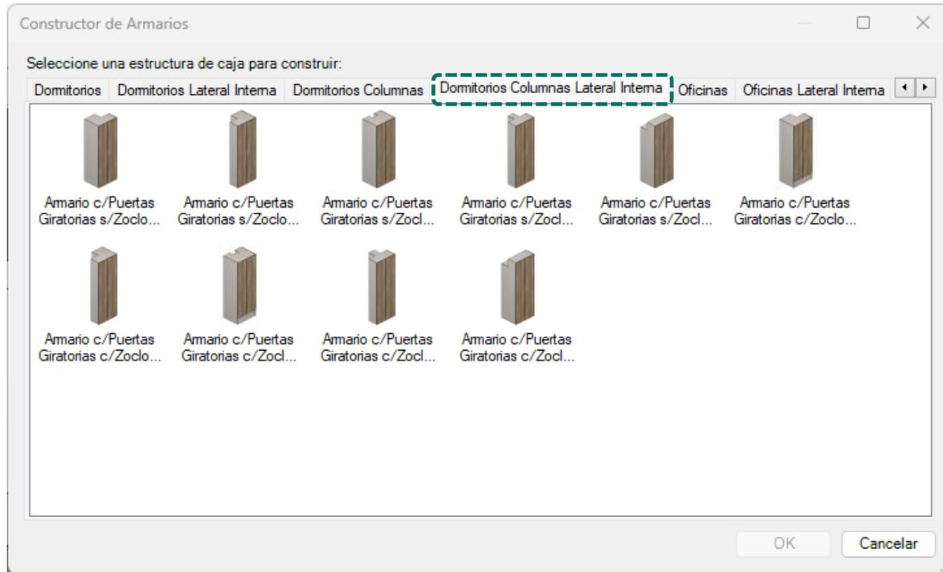
Los módulos de opción para columnas solo tienen la opción con **puertas vuelta** para ser utilizado para insertar puertas a través del **Constructor** (las particiones de vanos cortan las bases).
