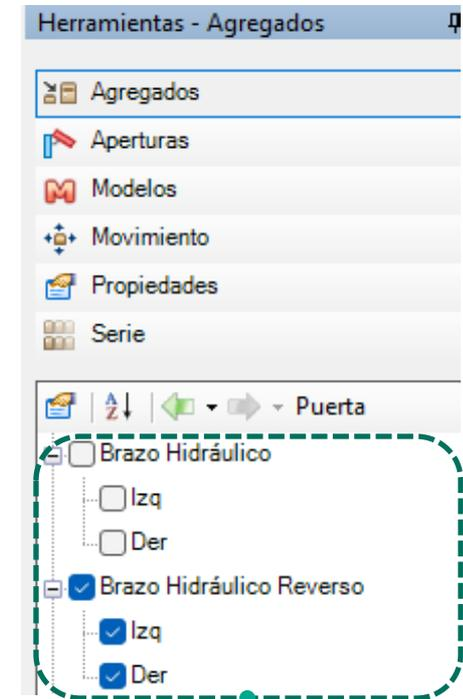
Los pistones añadidos al basculante se pueden elegir entre pistón con fuerza inversa o pistón convencional y se identifican como **PIST** y **PISTINV**. Los pistones **no** generan información de perforación y no tienen configuración.
