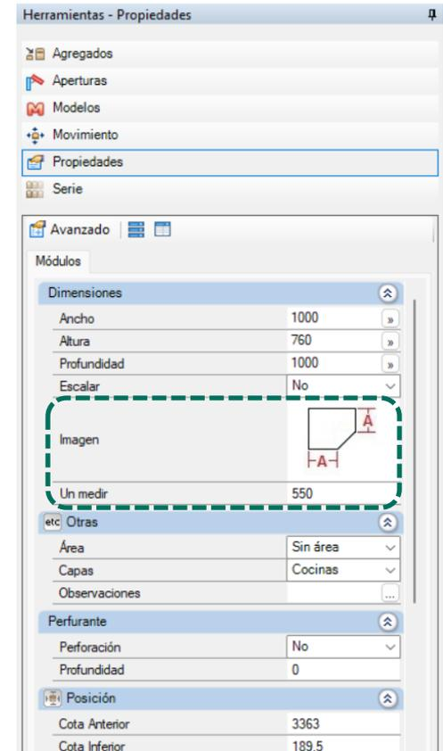
Los valores de las medidas **A** se pueden editar a través de las propiedades durante la construcción del proyecto. Base y Entrepaños enteras (enviado al optimizador de corte como una pieza entera, sin el diseño de la L). A través del **Configurador de Dimensiones** es posible elegir entre utilizar caja con recorte o sin recorte. La dimensión del **recorte de la Caja con Recorte** se puede definir a través del **Configurador de Dimensiones**.
