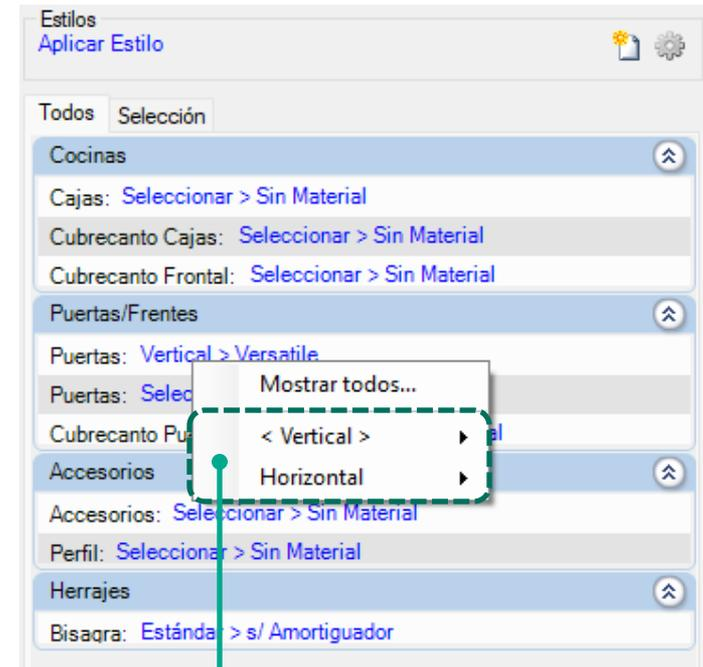
Para las **puertas de madera de montaje sencillo** es posible seleccionar la **dirección de la veta del material**, configurable a través de la pestaña de **Propiedades**.
