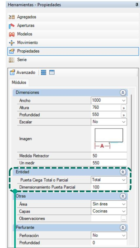
La puerta ciega se puede elegir entre Total o Parcial a través del **Panel de Propiedades**. La dimensión mínima de la puerta ciega parcial se puede editar utilizando el **Configurador de Dimensiones**.
