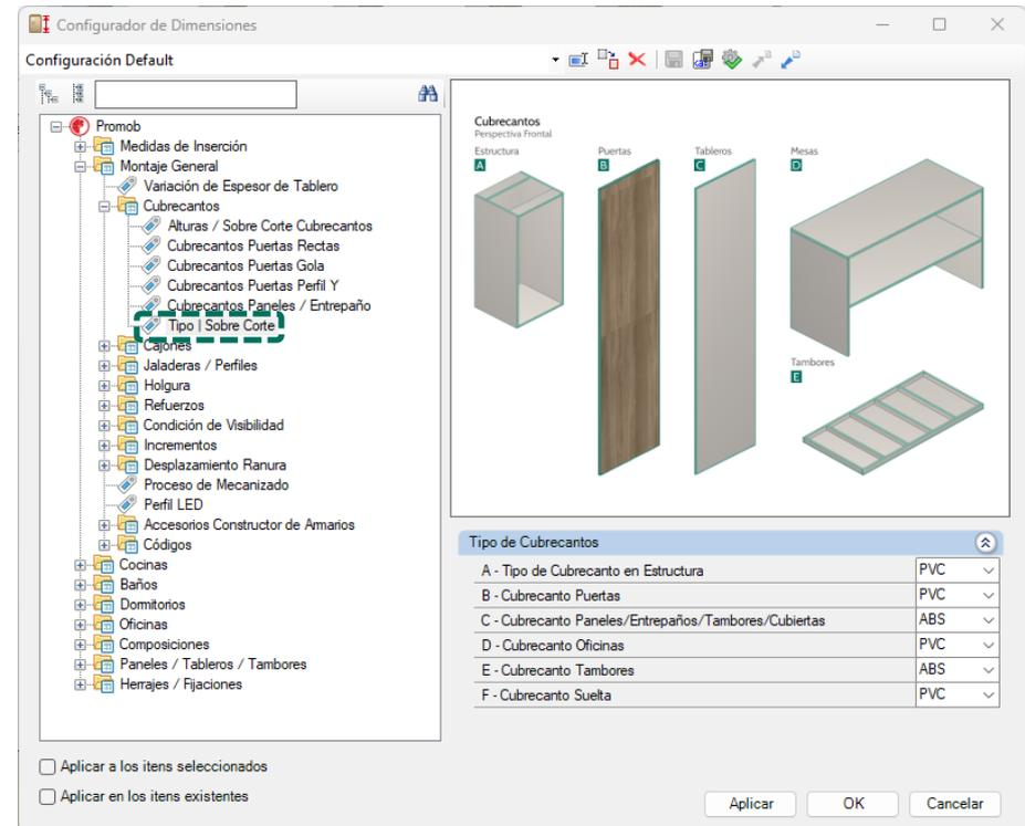
Se pueden definir diferentes tipos, **alturas** y **espesores** para **puertas** y **composiciones** de módulos. Son: **PVC** o **ABS**, alturas de **19, 22, 29, 35, 45** y **64mm** y espesores de **0,45, 1, 1,5** o **2mm**.
