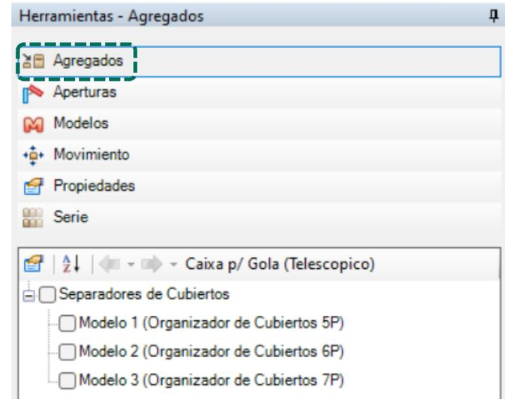
Los cajones pueden recibir como agregado un **divisor de cubiertos** según la anchura del cajón. Para insertar el divisor, acceda a la pestaña **Agregados**.
