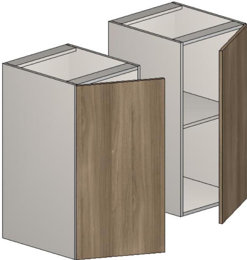
Con el módulo cerrado, pulse dos veces en la puerta que desea invertir y presione la letra **i** en el teclado, o pulse con el botón derecho en la puerta seleccionada y pulse en la opción **Espejar**.
