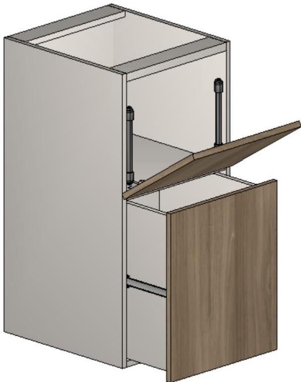
Los pistones acoplados a basculantes se identifican como pistones con fuerza inversa (PISTINV). Los pistones no generan información de perforación y no tienen configuración.
