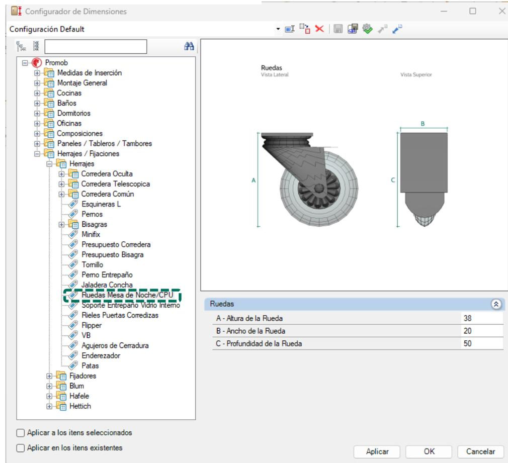
La altura de las ruedas se puede alterar a través del **Configurador de Dimensiones**.
