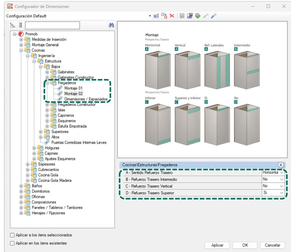
Posibilidad de insertar refuerzos delanteros dobles y refuerzos traseros intermedios e inferiores a través del **Configurador de Dimensiones**.
