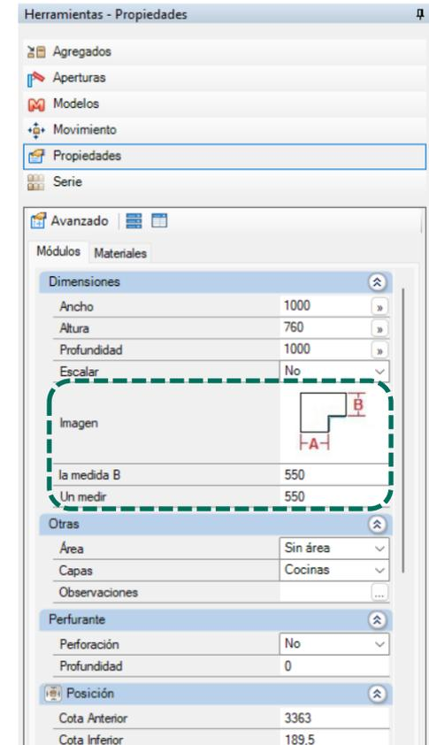
Los valores de las medidas **A** y **B** se pueden editar a través de las propiedades durante la construcción del proyecto. Base y Entrepaños enteras (enviado al optimizador de corte como una pieza entera, sin el diseño de la L). A través del **Configurador de Dimensiones** es posible elegir entre utilizar caja con recorte o sin recorte. La dimensión del **recorte de la Caja con Recorte** se puede definir a través del **Configurador de Dimensiones**.
