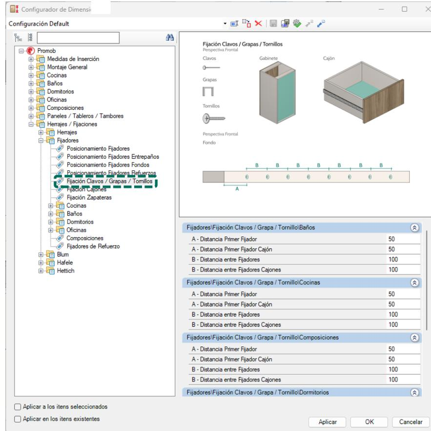
El espacio entre los agujeros utilizados para fijar los Fondos se define utilizando el **Configurador de Dimensiones**.
