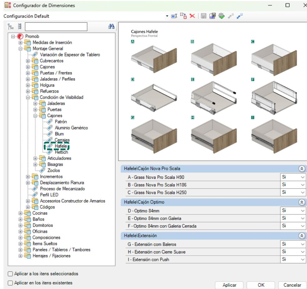
El uso de los elementos **Hafele** se definirá a través del **Configurador de Dimensiones** y sólo se insertarán con frentes de madera.
