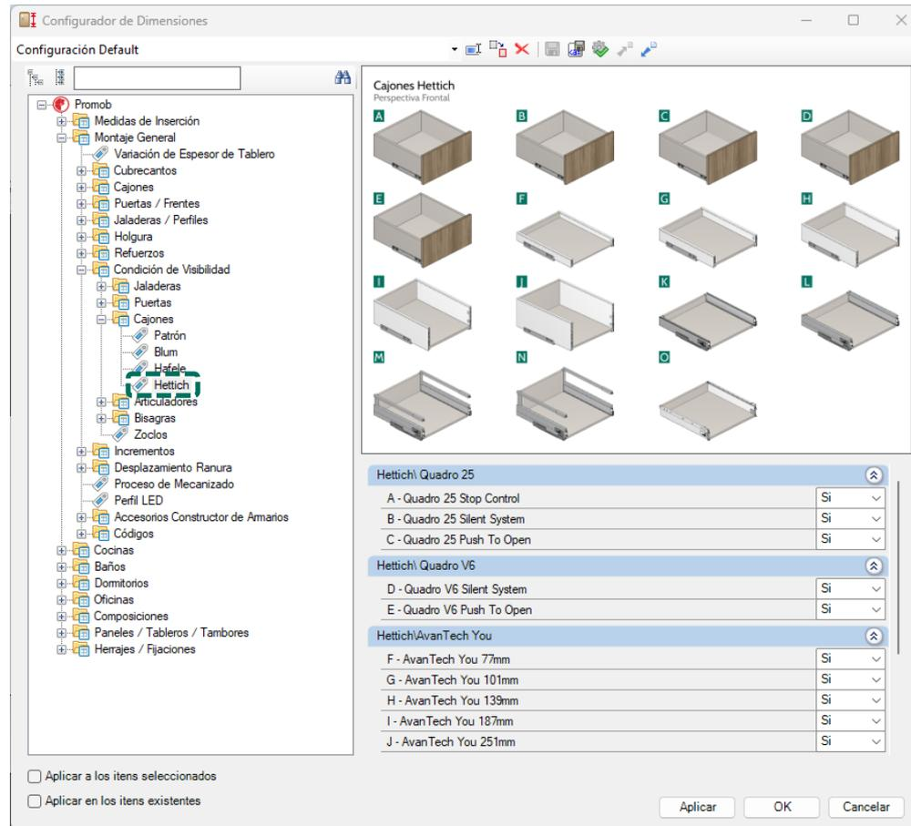
El uso de los elementos **Hettich** se definirá a través del **Configurador de Dimensiones** y sólo se insertarán con frentes de madera.
