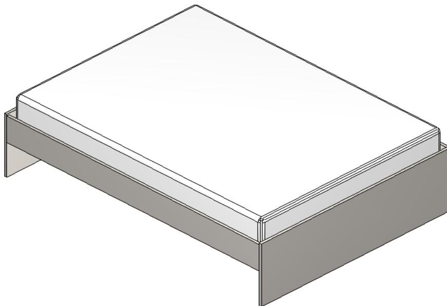
Las dimensiones de las camas doble plaza se calculan a través de las medidas de los colchones doble plaza definidas por el **Configurador de Dimensiones** más dos veces el valor de la holgura, también definida en el **Configurador de Dimensiones**. Las dimensiones de la altura de la cama, el ancho y la profundidad de los colchones y las compensaciones se pueden configurar con el **Configurador de Dimensiones**.
