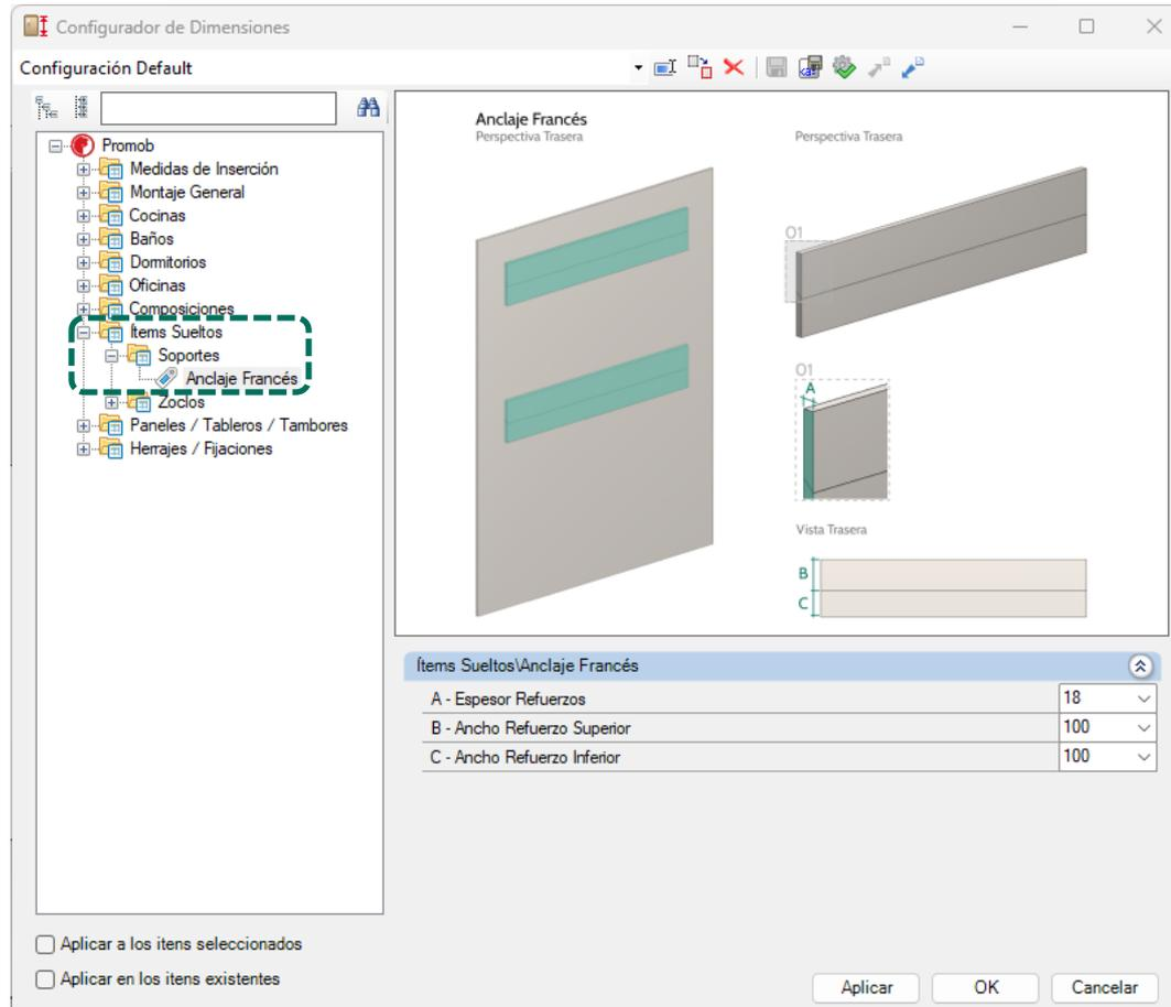
Es posible editar el **espesor** y el **ancho** de los refuerzos superior y inferior usando el **Configurador de Dimensiones**.
