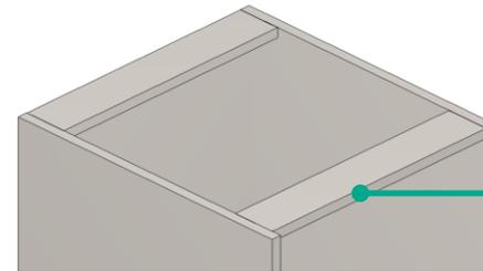
En los módulos inferiores con puertas articuladas, es posible realizar alteraciones del afastamiento de base y refuerzo frontal para recibir el refuerzo corte 45.
