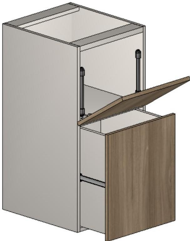
Os pistões agregados à basculante, são identificados como pistão com força inversa (PISTINV). Os pistões não geram informação de furação. Ver slide sobre pistões.
