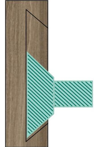
Para evitar marcas de entrada na superfície usinada, a linha de usinagem do processo Usinagem\_Cava deve iniciar fora da peça. Para isso, foi adicionado um atributo específico no configurador de dimensões.
