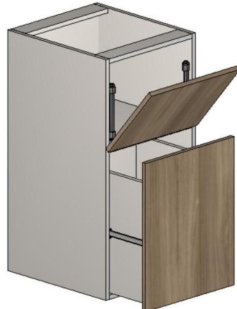
A **tábua de passar** agregada ao módulo **não** gera informações de furação. Os **pistões** agregados à basculante, são identificados como **pistão com força inversa** (PISTINV). Os pistões **não** geram informação de furação. Ver slide sobre pistões.
