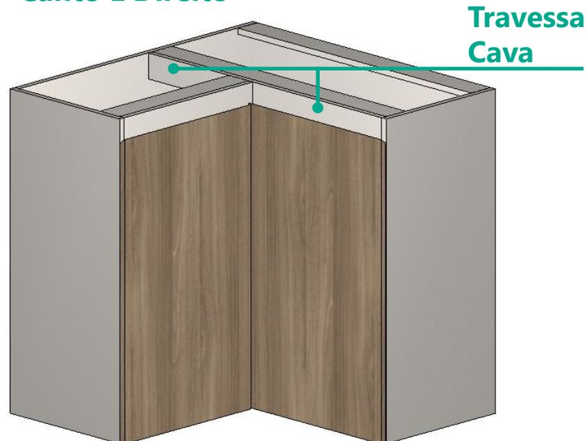
Os cantos L recebem as mesmas configurações de montagem e dimensões dos cantos L da linha de Cozinhas e possuem **Travessas Cava utilizadas como batentes das portas**. As Travessas Cava e as Travessas Horizontais recebem configuração de **dimensão, espessura e de fita de borda** e as portas recebem configuração de **avanço sobre a travessa**.
