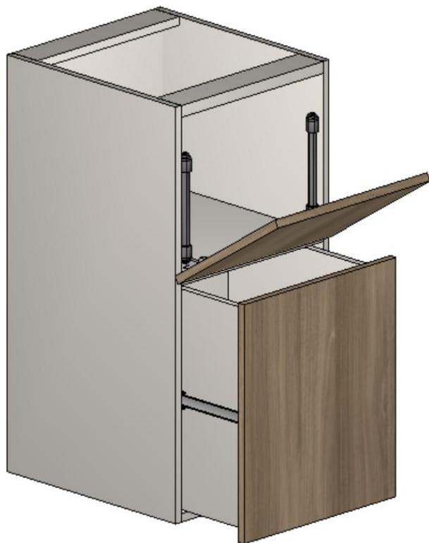
Los pistones acoplados a basculantes se identifican como pistones con fuerza inversa (PISTINV). Los pistones no generan informaciones de perforación y no tienen configuraciones.
