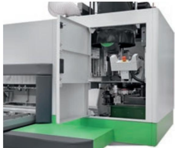
Depósitos com corrente de 14/21 e 22/33 posições.
