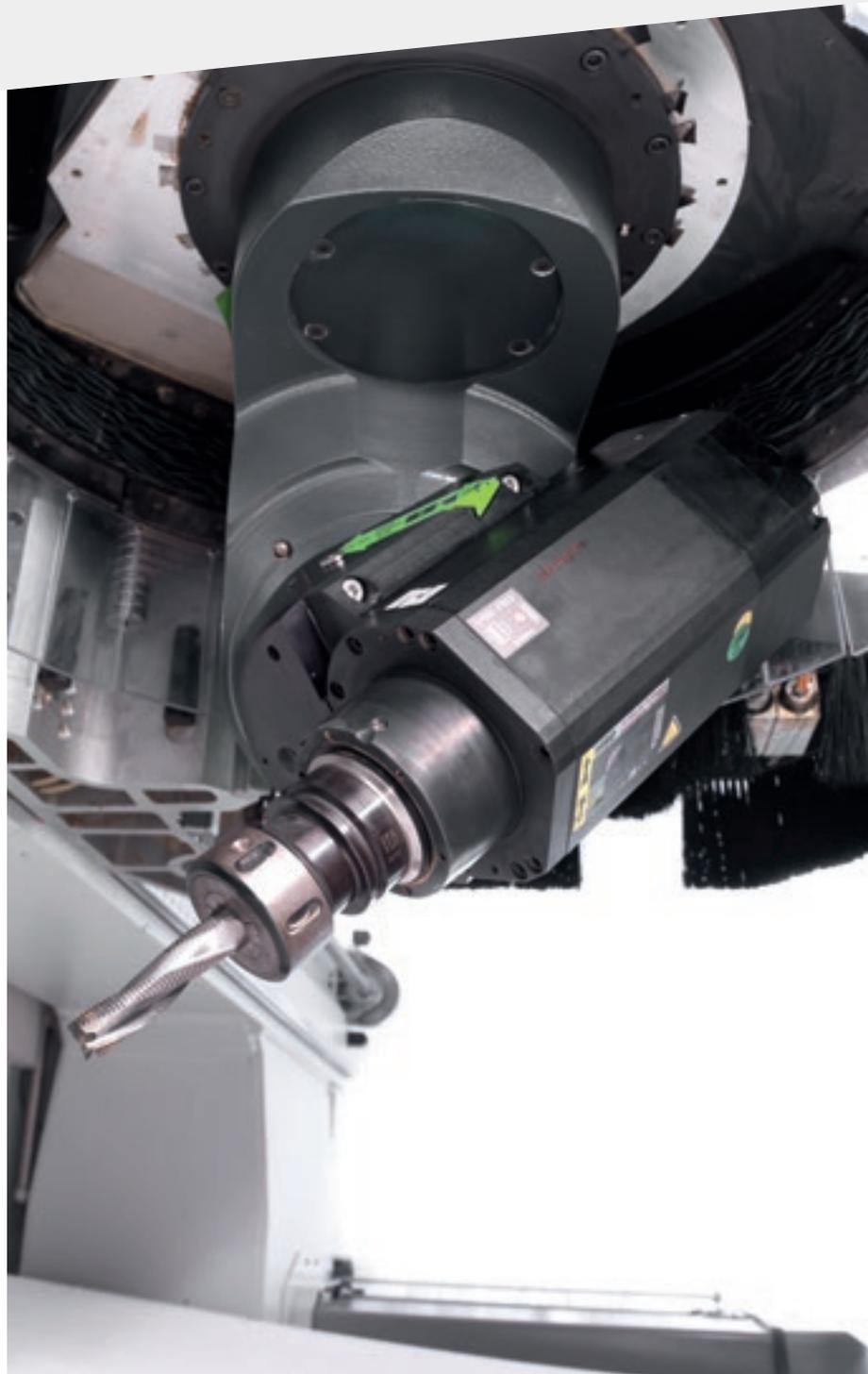
A unidade de 5 eixos de 16,5 kW, o eletromandril de 19,2 kW e 6 rolamentos de cerâmica grandes garantem altas taxas de desbaste e máxima qualidade de acabamento.
