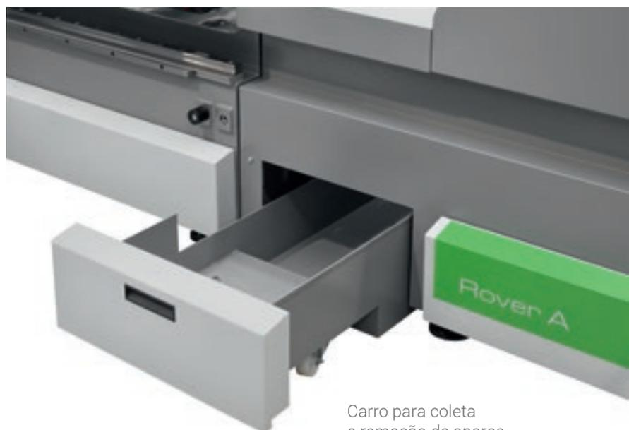
Carro para coleta e remoção de aparas e descartes.
