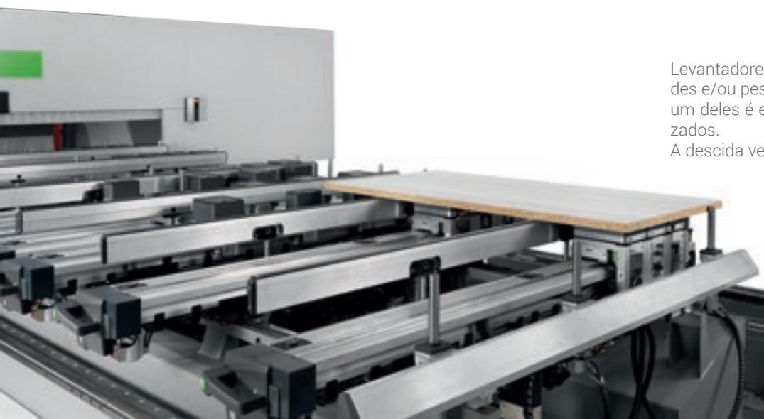
Levantadores para ajudar carregar peças grandes e/ou pesadas. Fabricados em alumínio, cada um deles é equipado com dois cilindros sensorizados.
