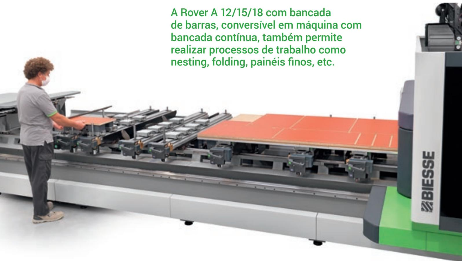
O corte no modo nesting permite obter peças, sob medida já quadradas, a partir de um painel de tamanho grande. Cada peça pode ser completada na área de trabalho oposta, com todos os processamentos que não podem ser realizados em uma bancada de trabalho contínua (furos horizontais, trabalhos de entalhe, etc.).
