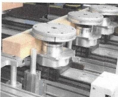
**Las barras de soporte** rectificadas y de aluminio extruido, con amplia base de apoyo, se deslizan por el eje X sobre guías redondas templadas y el mecanismo de bloqueo y desbloqueo neumático rígido y seguro está compuesto por dos frenos neumáticos (uno en la barra de deslizamiento delantera y otro en la trasera).
