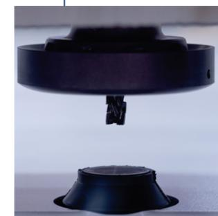
MEDIDOR DE COMPRIMENTO DA FERRAMENTA
