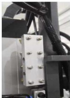
Aplicação manual de graxa no controle deslizante do fuso superior
