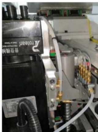
Aplicação manual de graxa no controle deslizante do fuso inferior
